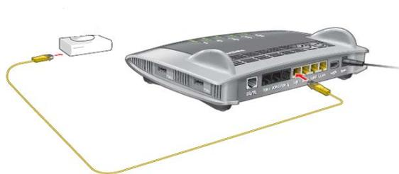
Verbinden Sie den LAN- bzw. **GE-Port** des Glasfasermodems über ein Netzwerkkabel mit dem **WAN-Port** der FRITZ!Box oder **LAN1-Port** falls kein **WAN-Port** vorhanden ist.
