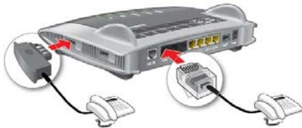
Schließen Sie Ihr analoges Telefon an die Buchse „FON 1“ an. Die FRITZ!Box hat diese Buchse in zwei Ausführungen: hinten für RJ-11 und seitlich für TAE-Stecker.
