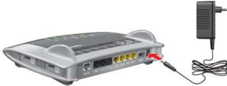
Schließen Sie die FRITZ!Box am Strom an. Die Leuchtdiode „Power/DSL“ beginnt zu blinken.
